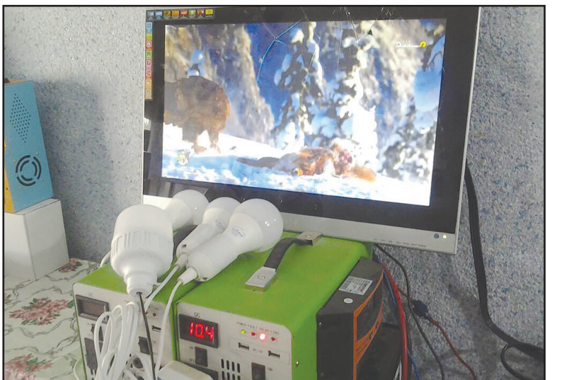
نمونه‌ای از یک نیروگاه خورشیدی عشایر با برق لازم برای چهار لامپ LED و شارژ موبایل و یک تلویزیون متوسط و امورات برق آغل حیوانات با یک دزدگیر و روشنایی و دوغزن برقی که معادل یک موتور برق معمولی می‌باشد که بدون هیچ مخارج جانبی از بنزین و روغن و غیره و بدون دود و گاز و سر و صدا و تعمیرات، همه و همه فقط با استفاده از نور سفید خورشید انجام می‌گردد.
